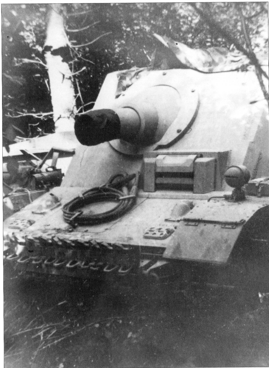
In an assembly area. The vehicles do not have a coating of Zimmerit yet. In this instance, these vehicles also have the Panzer III -style air intakes. • In Bereitstellung. Die Fahrzeuge haben noch keinen Zimmeritanstrich. Auch hier sind auf den Lenkbremsen-Wartungsluken Pz.Kpfw. III Lufteinlässe montiert.
