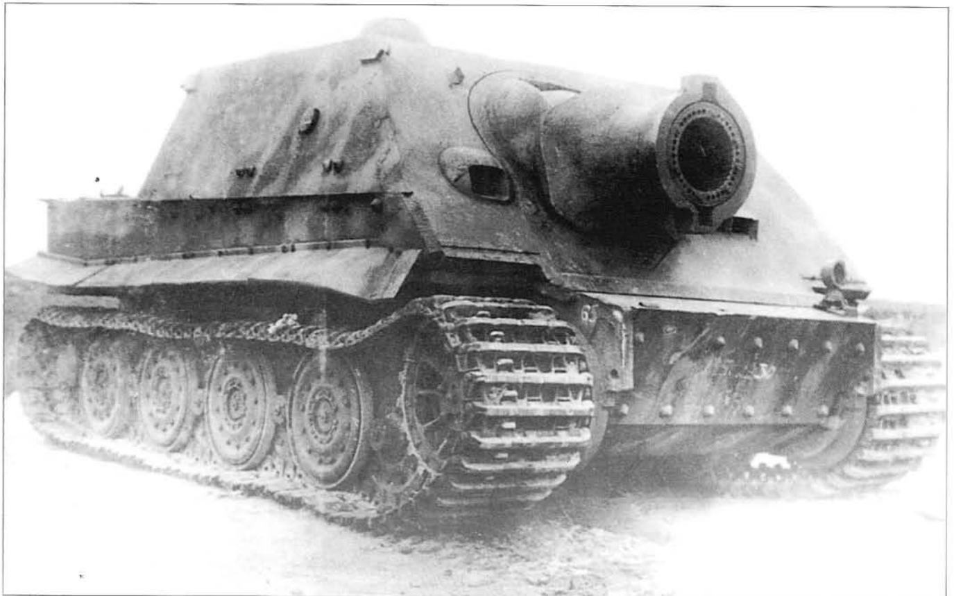
The same vehicle seen from another angle. The bolted-on supplemental armor plating on the front of the hull can be seen to good advantage. • Das gleiche Fahrzeug aus einer anderen Perspektive. Gut erkennbar die aufgeschraubte Zusatzpanzerung am Wannenbug
