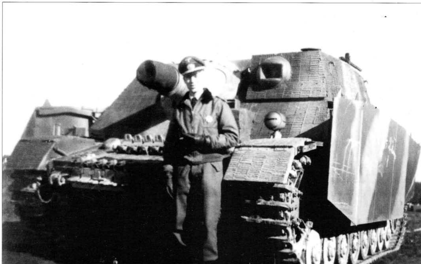
This assault tank has been given a thorough coating of Zimmerit . It has even been placed on the mudguards. • Der Sturmpanzer ist mit einer umfassenden Zimmeritbeschichtung versehen. Sogar auf den Kettenabdeckungen ist dieser aufgetragen.
