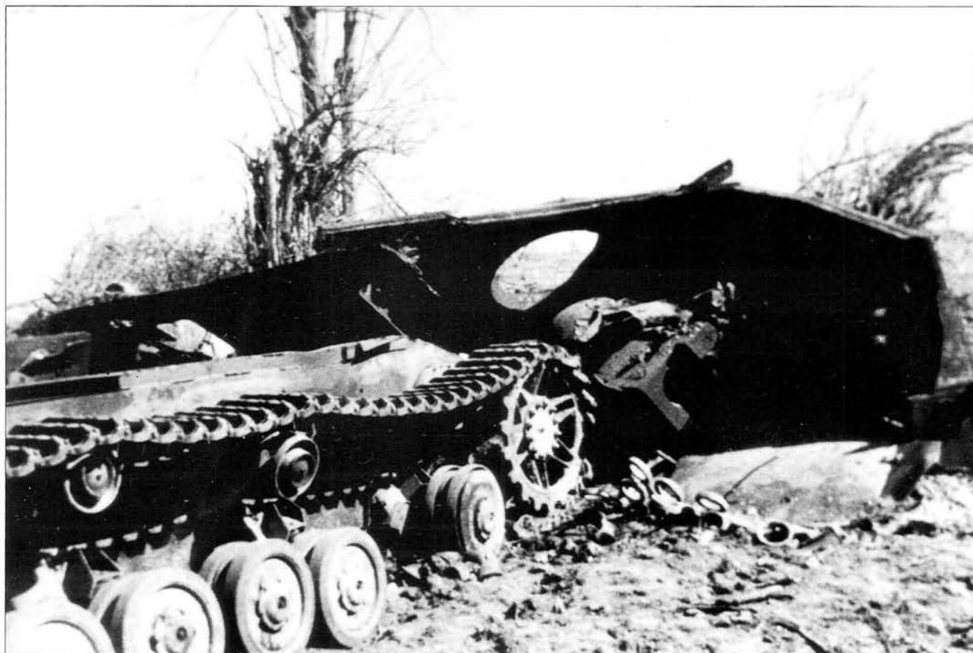
Several assault tanks of the 1st Company were lost as the result of faulty ammunition. This destroyed assault tank only had steel roadwheels on its front set of bogies. • Mehrere Sturmpanzer der 1.Kompanie gegen durch fehlerhafte Munition verloren. Bei diesem zerstörten Panzer waren nur der vordere Laufrollenwagen mit Stahllaufrollen ausgerüstet.
