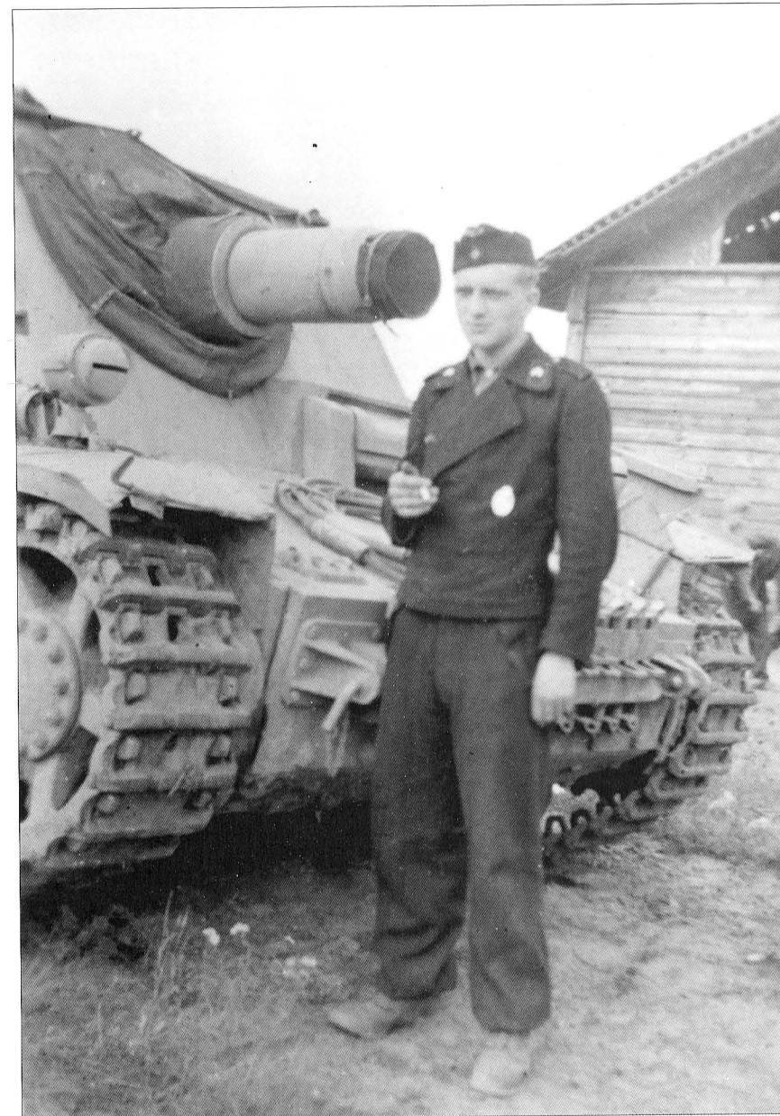
Supplemental armor plate has been added to the front of the hull. • Am Wannenbug ist zur Verstärkung eine Panzerplatte angebracht.
