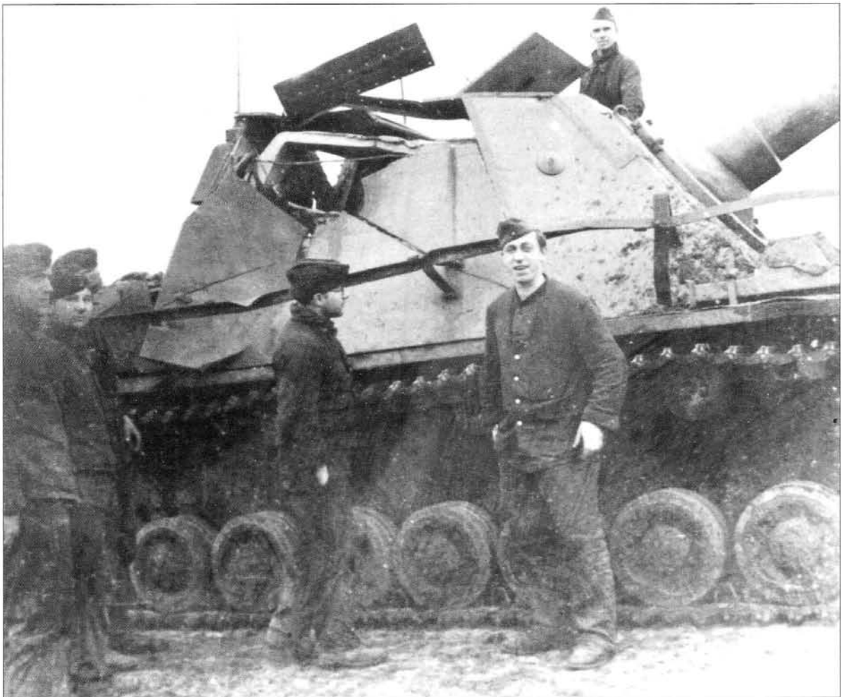
A total loss. This assault tank was destroyed on the right-hand side by an artillery round. • Totalschaden. Der Sturmpanzer wurde durch einen Artillerietreffer auf der rechten Aufbauseite zerstört.
