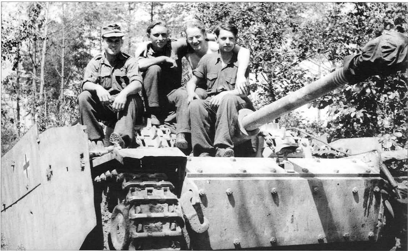
The supplemental armor plating added to this vehicle can be seen to good advantage. • An diesem Geschütz kann man gut die zusätzlich angebrachte Bugpanzerung erkennen.
