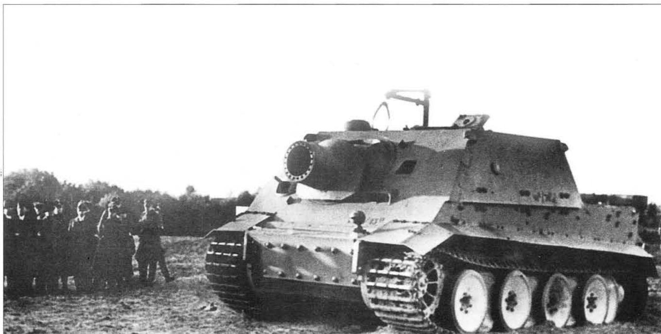
Demonstration of the Sturmtiger for Hitler. The lifting shackles on the crane can be seen to good advantage. • Vorführung des Sturmtiger-Prototyps vor Hitler. Gut erkennbar das Hebegeschirr am Ladekran.
