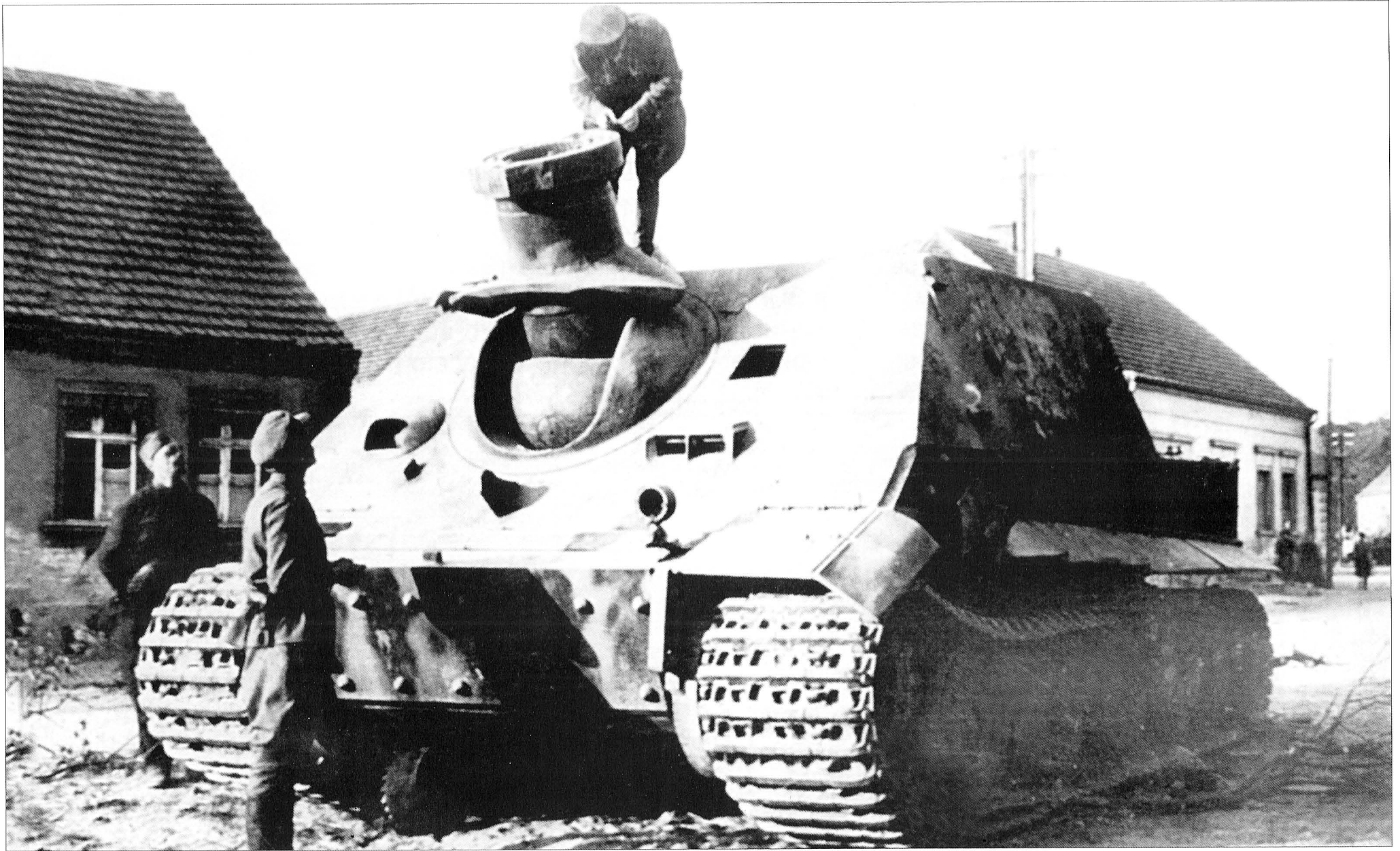
During the final fighting in the East, the Soviet forces were able to capture the prototype of the Sturmörser . The prototype was outfitted with a steel superstructure and steel roadwheels after it returned from employment in Warsaw. The vehicle is currently on display at Kubinka. • Beim Endkampf im Osten erbeuteten die sowjetischen Streitkräfte den Prototyp des Sturmörser. Dieser wurde nach seiner Rückführung aus Warschau mit einem Stahlaufbau und Stahlaufrollen ausgerüstet. Der Panzer steht heute im Museum in Kubinka
