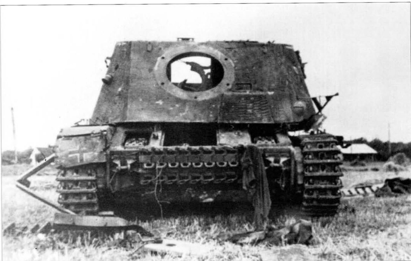
The 15-centimeter assault howitzer is missing and the superstructure has been displaced to the side. Note the Balkenkreuz on the right front mudguard. • Die 15cm Sturmhaubitze 43 fehlt, der Aufbau ist seitlich versetzt. Man beachte das Balkenkreuz auf der rechten vorderen Kettenabdeckung.
