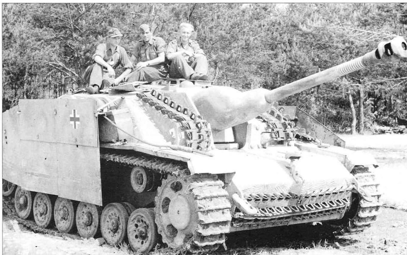
Note the mounting of additional track links to the right and left of the main gun. • Man beachte die Anbringung der zusätzlichen Kettenglieder am Aufbau rechts und links neben der Kanone.
