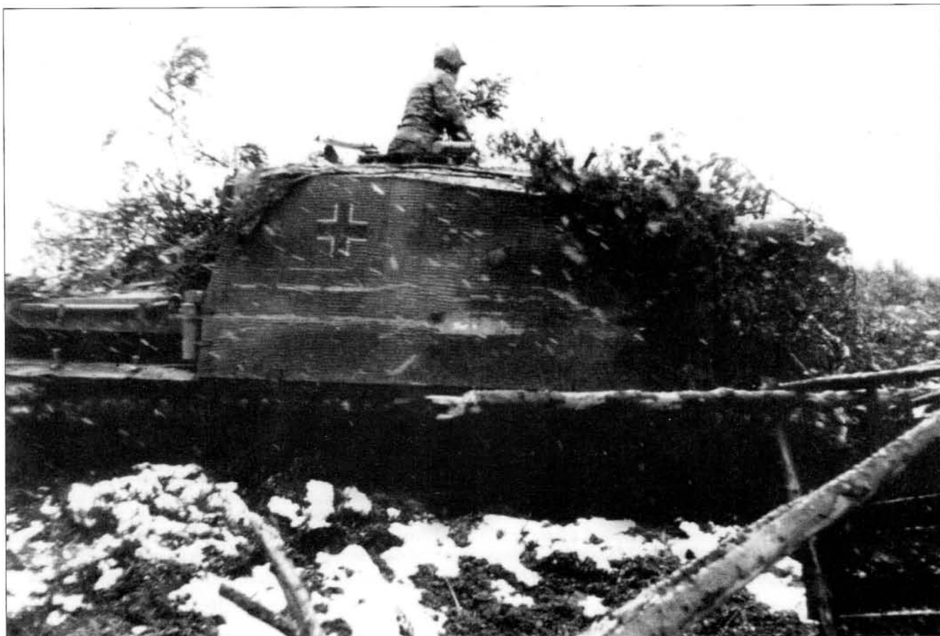
The assault tank has been given a complete coat of Zimmerit and features a three-tone camouflage scheme. • Der Sturmpanzer ist mit einem vollständigen Zimmeritanstrich versehen und trägt einen dreifarbigem Tarnanstrich.
