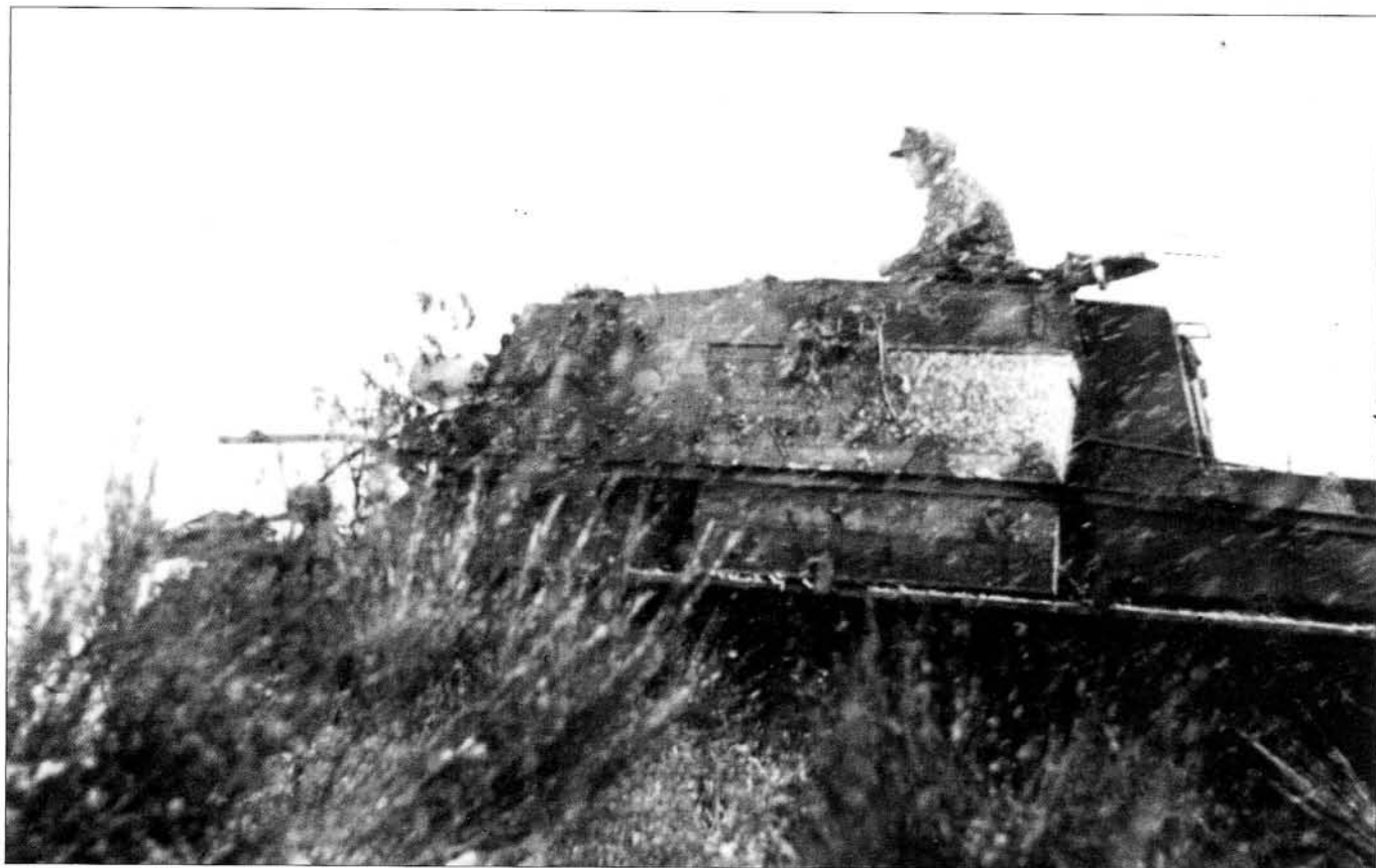
A wooden crate has been added to the left side of the superstructure in a field-expedient manner by the crew. • Behelfsmäßig wurde eine Holzkiste an der linken Aufbauseite von der Truppe angebracht.
